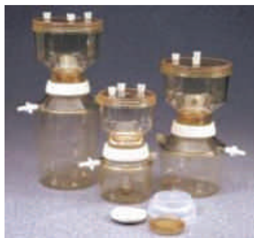
Figura 207 - Sistemas de filtração de líquidos
