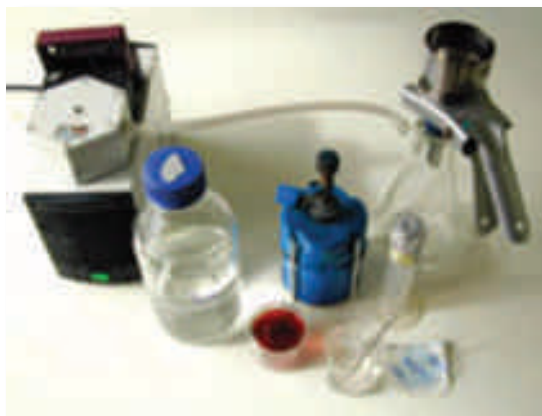
Figura 208 - Sistema de filtração e respectiva bomba de vácuo
